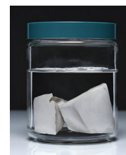
Figure (9) Le sodium est conservé au-dessous des huiles minérales
