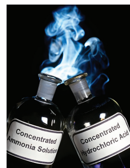
(Figure 24) Détection de gaz ammoniac
